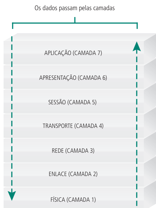
Figura 2.2: As sete camadas do modelo OSI
