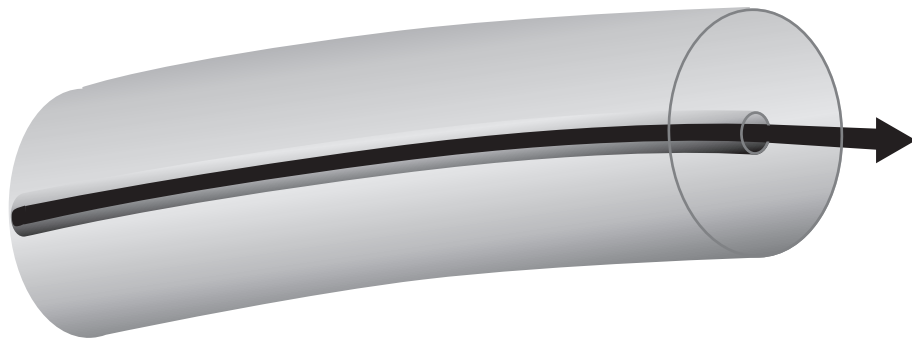
Figura 4.8: Transmissão num cabo de fibra monomodo
